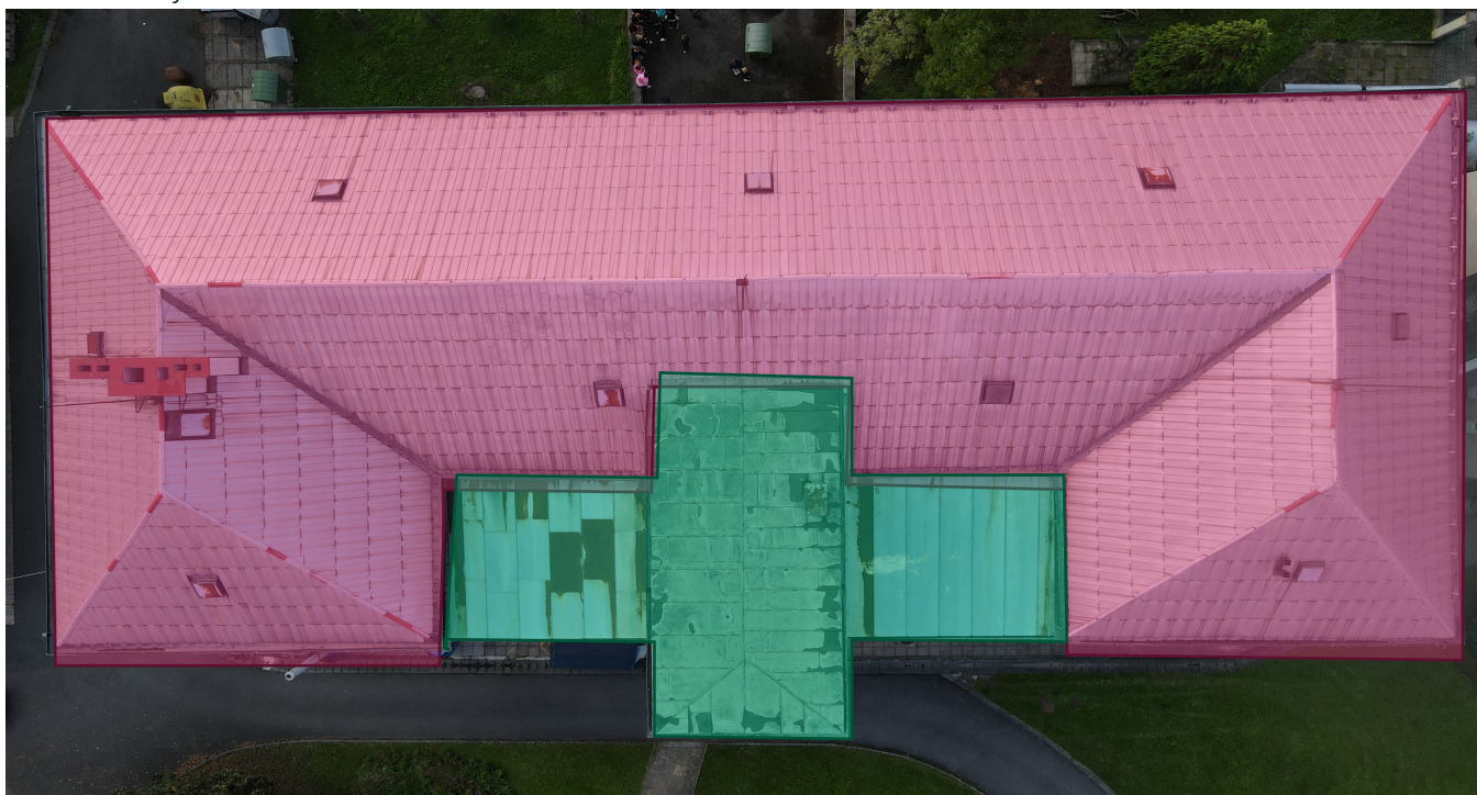
Obrázek č. 1: Vyznačené střešní konstrukce určené k rekonstrukci - hlavní budova
